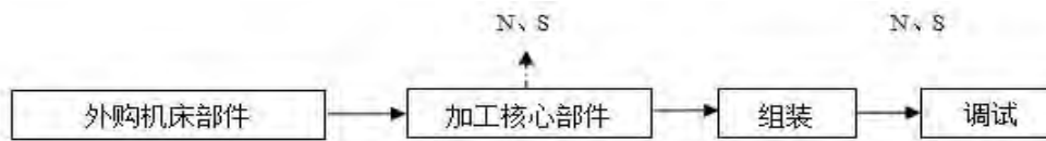
图 3 数控转塔冲床生产工艺流程及产污环节图
